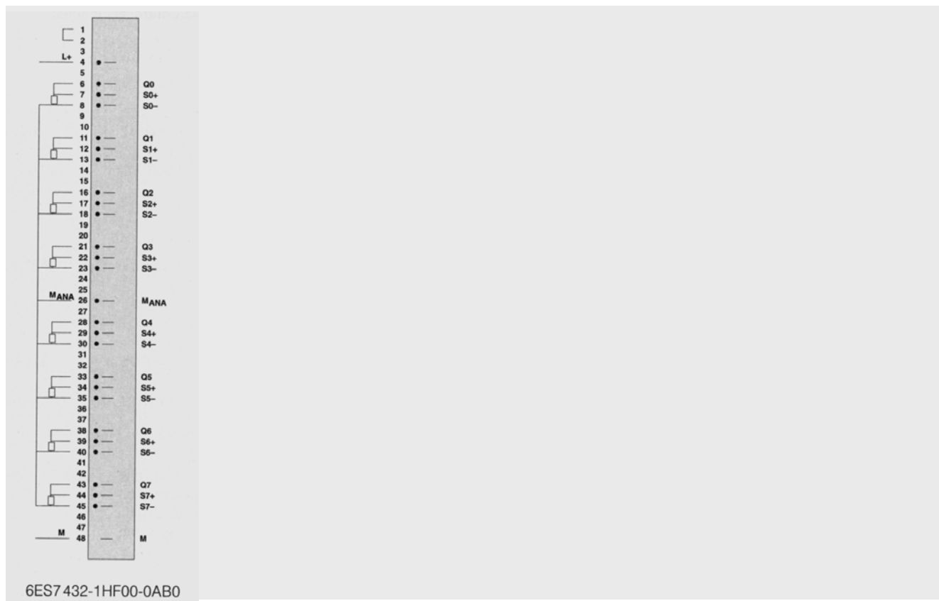
图 20 模拟量输出模板的端子接线图
