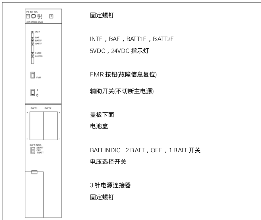
图 3-4 PS 407 10A 和 PS 407 10A R 的控制和指示灯
