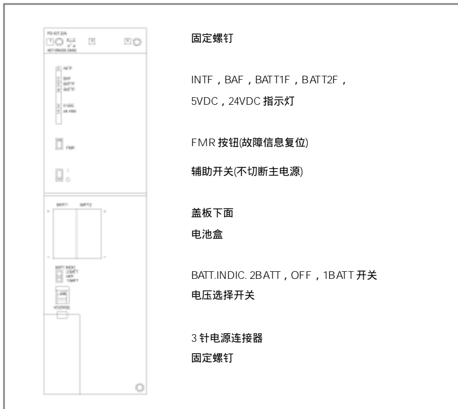
图 3-1 PS 407 20A 电源模板上的控制和指示灯
