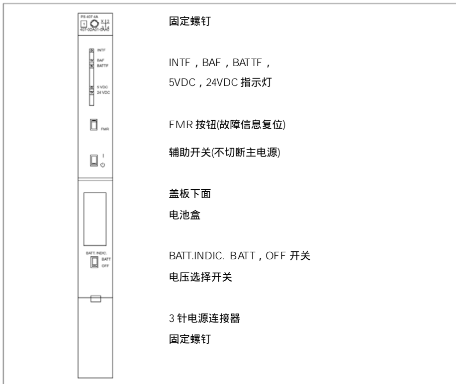
图 3-3 PS 407/4A 的控制和指示灯
