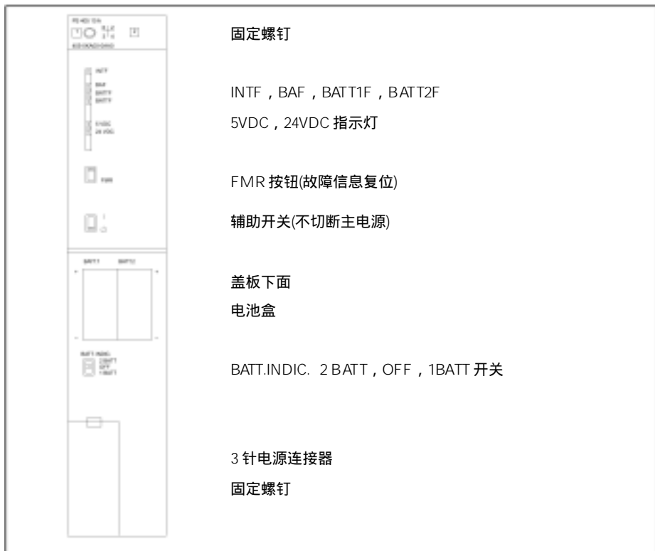
图 3-9 PS 405/10A 的控制和指示灯
