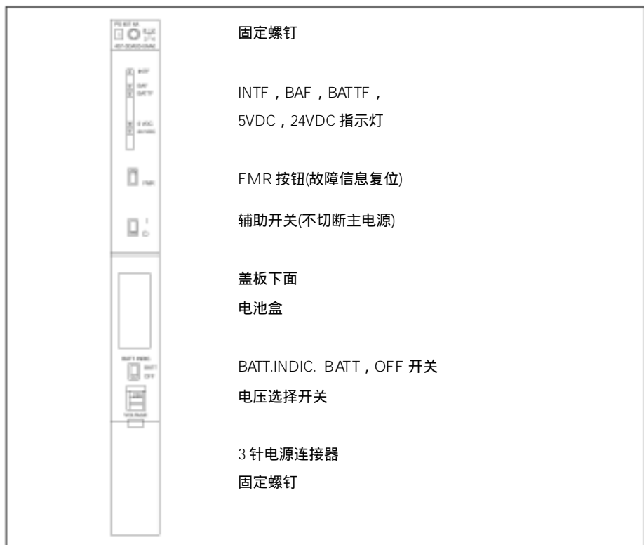
图 3-2 PS 407/4A 的控制和指示灯
