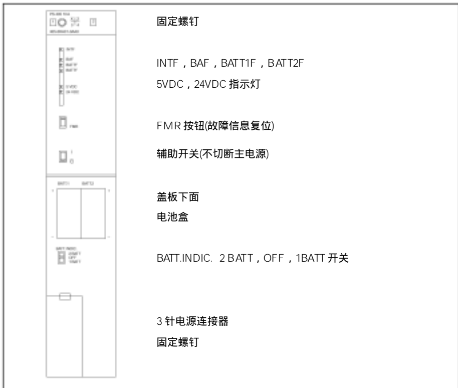
图 3-10 PS 405/10A 和 PS 405/10A R 的控制和指示灯
