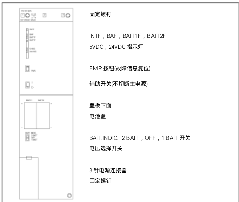
图 3-6 PS 407/20A 的控制和指示灯
